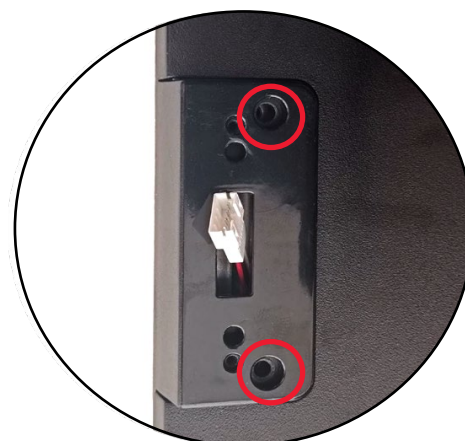
Рисунок 6. Расположение винтов крепления
