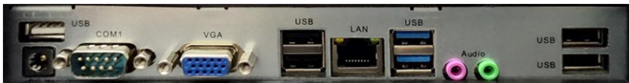
Рисунок 2. Панель с разъёмами для подключения внешних устройств
