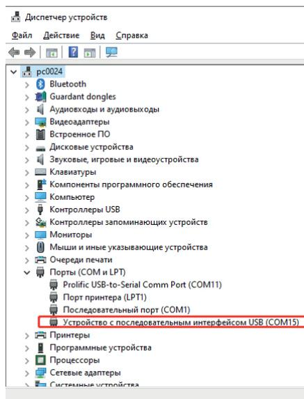
Переходим в Диспетчер устройств операционной системы, подключаем QR дисплей к USB порту ПК, нажимаем и удерживаем кнопку включения на нижней части дисплея в течении 7 секунд до включения дисплея. Контролируем номер появившегося COM порта, в данном примере это 15.
